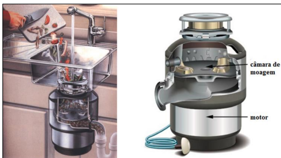
Figura 1 - Esquema de um triturador de resíduos alimentares
