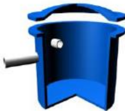
Figura 9 - Caixa de distribuição de esgoto
